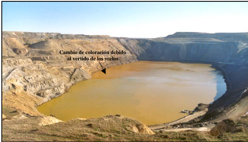
Figura 7.3. Corta de Aznalcóllar en el año 2002 durante el vertido de los suelos de Entremuros almacenados en las instalaciones mineras.
